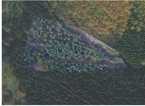
実際にエクスポートしたオルソモザイク画像。無調整でGISの背景に概ねピッチャー一致。
